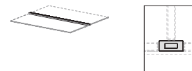
central metal profile PE9248 L80 P5 H1,8 PE9250 L100 P5 H1,8 PE9252 L120 P5 H1,8 PE9253 L125 P5 H1,8 PE9254 L140 P5 H1,8 PE9256 L160 P5 H1,8 PE9257 L165 P5 H1,8 PE9258 L180 P5 H1,8 PE9260 L200 P5 H1,8
